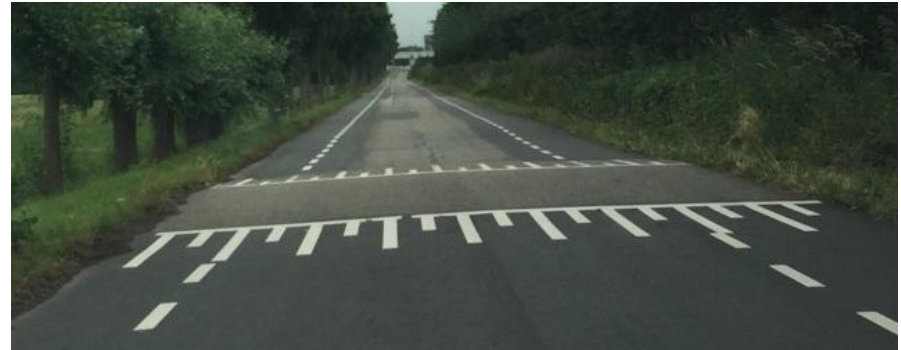
Voorbeeld van een type drempel die geschikt zou kunnen zijn binnen een industriezone
