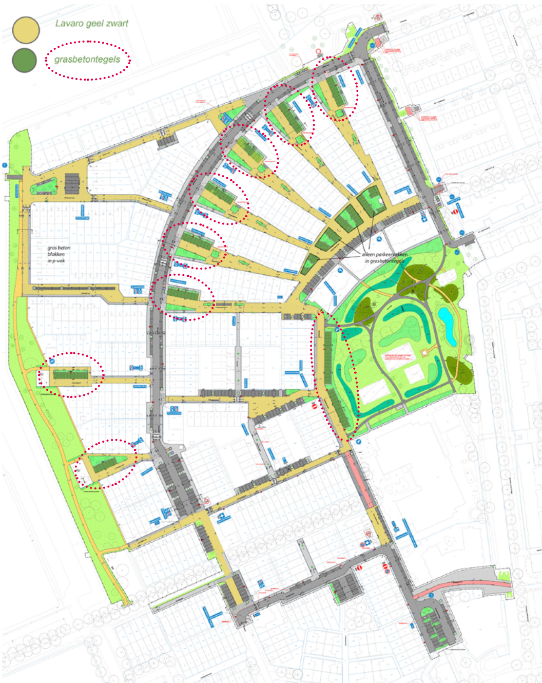
Situatie grasbetontegels en gekleurde straatstenen.
