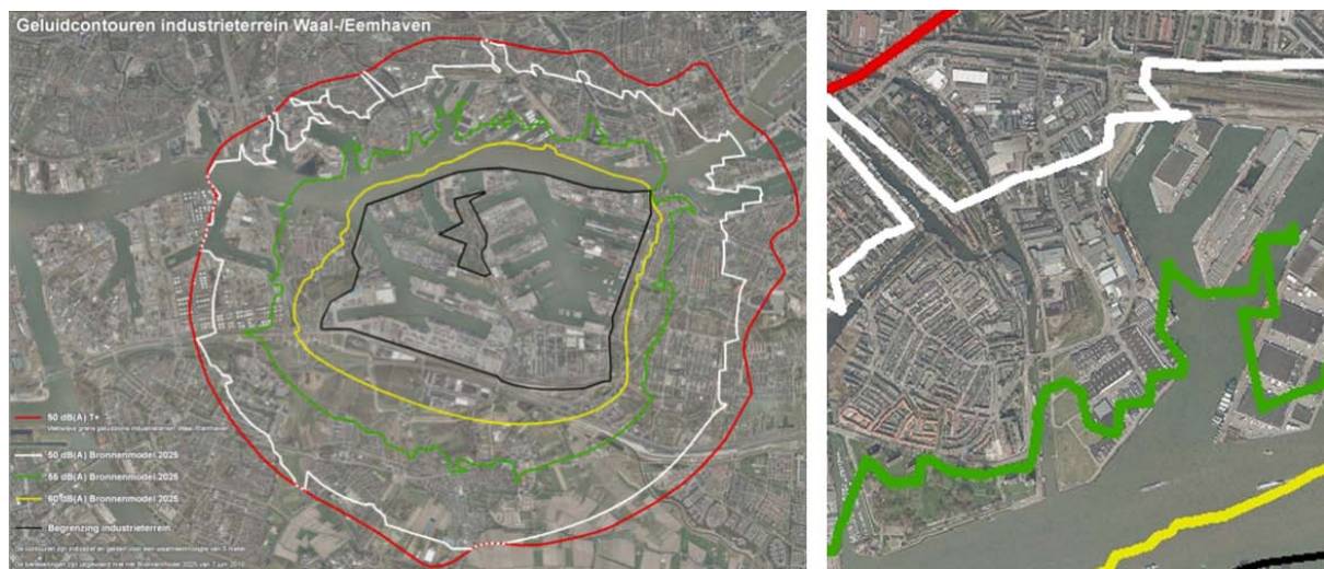
Afbeelding 11 - Geluidscontouren Waal-Eemhaven, wettelijke zonegrens (rood) en 50 dB(A)-contour (wit)
