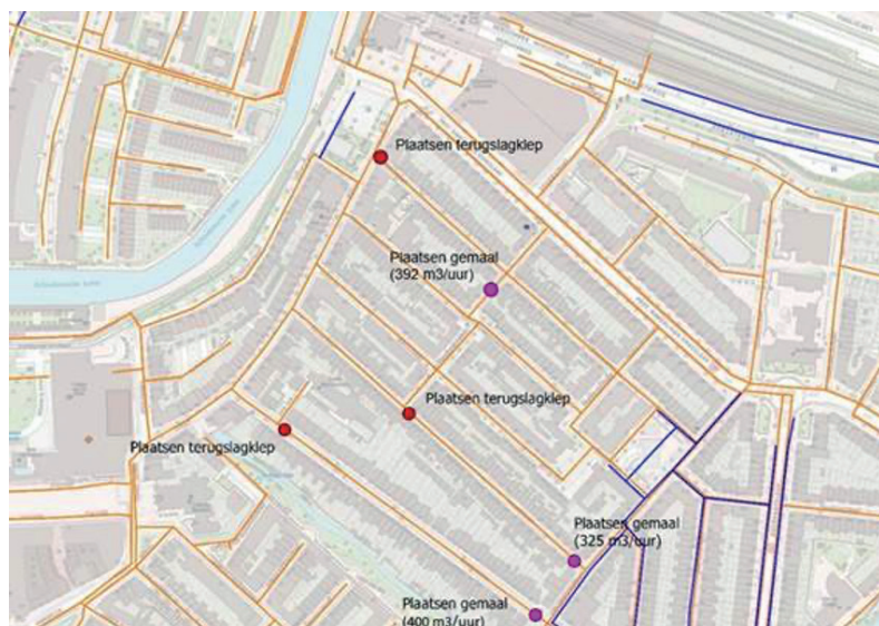
1e fase; vanaf kwartaal 3 2020 - plaatsen pompen en terugslagkleppen Villastraat/Oostsingel
