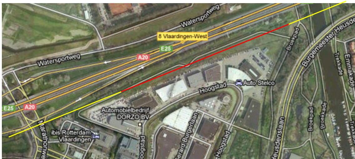
Figuur 5.17: Traject van de Marathonweg - Broekpad. De gele lijn toont een gestuurde boring, rood is een open ontgraving (Bron: Google Maps).
