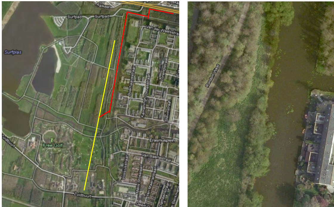
Figuur 5.13 Traject van het Surfpad. De gele lijn toont een gestuurde boring, rood is een open ontgraving. Op de rechterfiguur is een gedeelte van het traject in meer detail zichtbaar met het wandelpad, de bomenrij, een grasstrook, oeverbegroeiing, kanaal en een woning (Bron: Google Maps).
