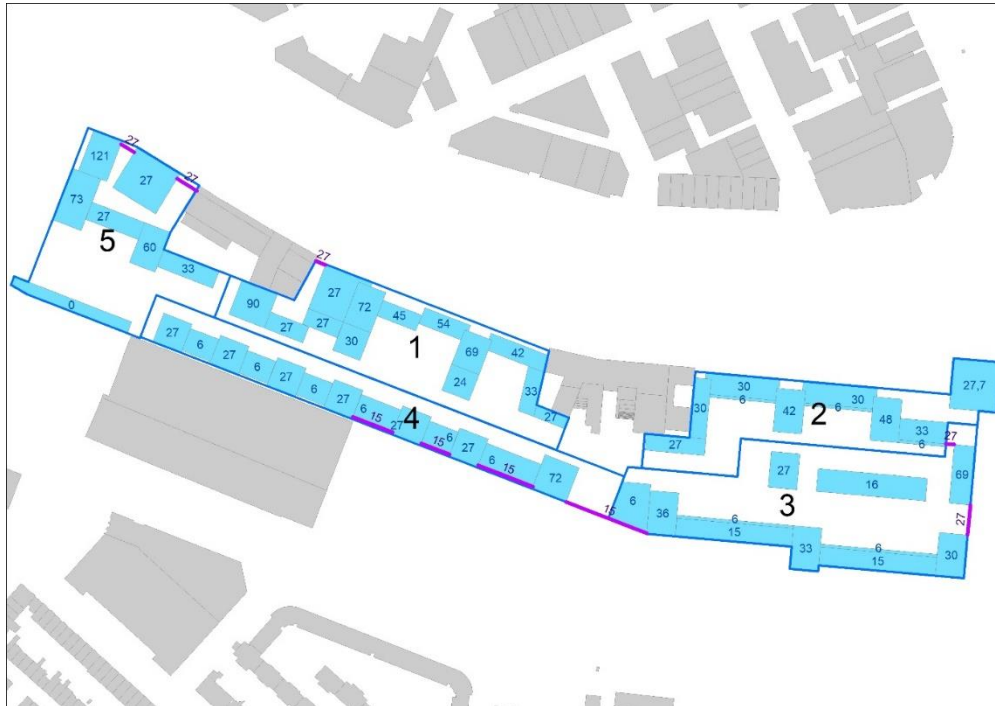
Figuur 7-3: Beoogde bouwhoogtes nieuwbouw Schieveste en minimale benodigde geluidwerende voorzieningen (paarse lijnen, inclusief hoogte in meters ten opzichte van maaiveld), voor en tussen de nieuwbouw aan noord- en zuidzijde (alternatief Masterplan)
